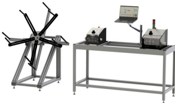
Schwenkbarer Haspel HA1000, Bandvorschub BV30 sowie AC30 auf Arbeitstisch montiert.
